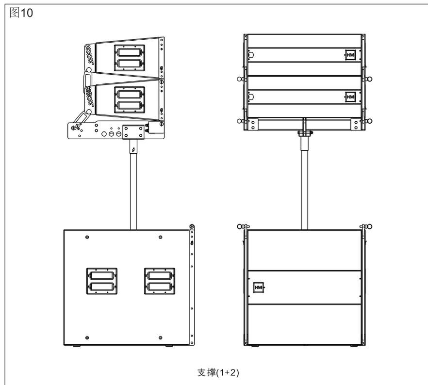
注：当全频与超低或全频与吊顶架相连时，“Z”表示堆叠或支撑模式；“D”表示吊挂模式；当全频与全频相连时，“D”表示吊挂、支撑和堆叠三种模式；数字为对应角度，“B”为限位孔。如D3°为吊挂3°的定位孔，D3°B为吊挂3°的限位孔，Z0°为堆叠或支撑0°的定位孔，Z0°B为堆叠或支撑的0°限位孔。(如下图)
