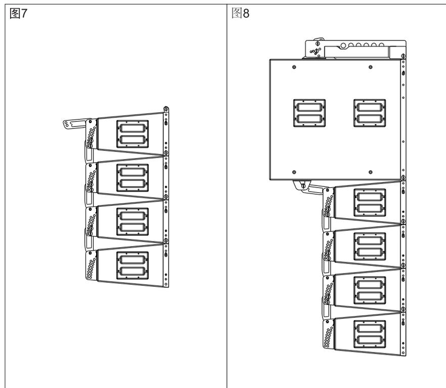
注：1) 如采用4只全频此时已完成吊装操作。如需更改调节角度，只需放下葫芦通过箱体后连接件进行具体角度调节即可。
