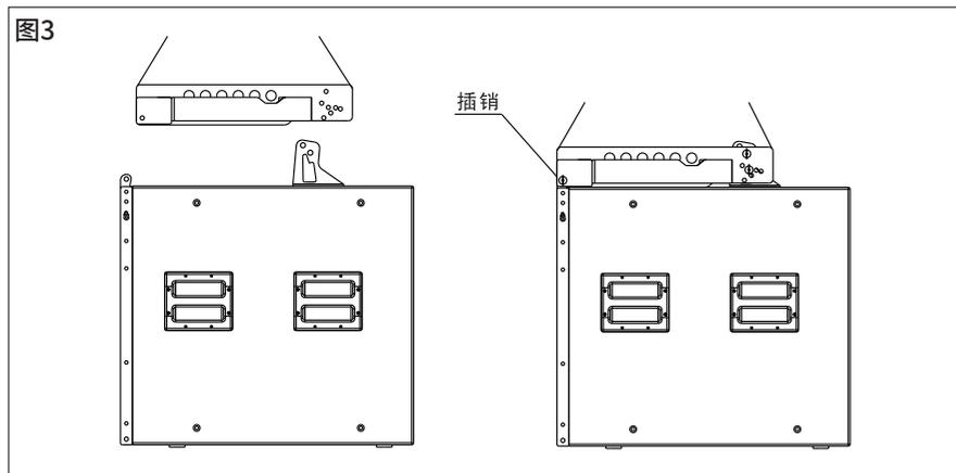
注：此为只用1只超低频音箱的步骤，如用两只超低频音箱，需先拆除第一只超低频音箱的上、下连接片，再拆除第二只箱的上连接片(即长片)，并将田字架附件里的两个连接片分别装在两只超低频音箱的背部(如图4)，将原来拆出的插销分别锁到两个后连接件上(连接件有一个M5的螺丝，拆出即可将插销固定进去，每个箱两个插销)。再按第三步连接第一只超低频音箱，此时3.2的中间上连接片已拆除换成后连接片，将后连接片拔出转动到吊架的相应孔位插入插销，重复第二第三步的步骤将第二只超低频音箱也连接好并升起葫芦。
